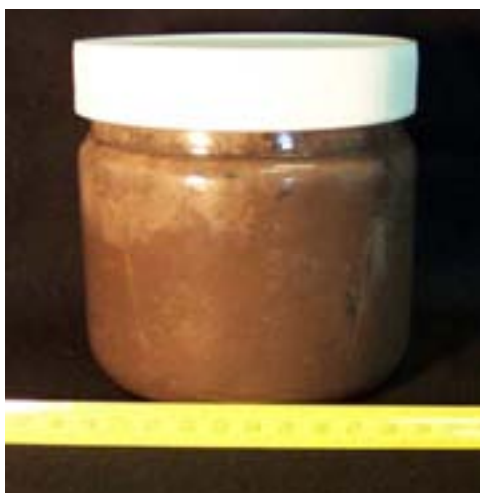
Figura III.10. Aspecto de los microcosmos conteniendo suelo contaminado proveniente del polo petroquímico La Plata-Ensenada
