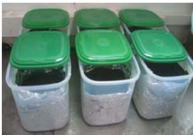
Figura III.9. Aspecto general y detalle de los microcosmos conteniendo suelo contaminado en forma aguda con gasoil y sometidos a un proceso de bioaumentación con un consorcio bacteriano (MAD) inmovilizado en diferentes matrices inertes.
